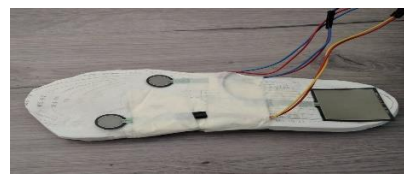
SI. 4. Uložak u kojem su postavljena 3 FSR senzora [7]
