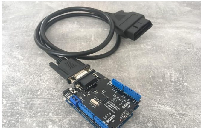
Sl. 3 CAN Logger sa OBD2 konektorom
