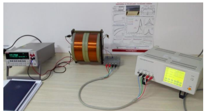
Slika 4. Eksperimentalna postavka merenja magnetoimpedanse po metodi četiri tačke pomoću instrumenta LCR Hi-TESTER HIOKI 3532-50, f \in [42 \text{ Hz}, 5 \text{ MHz}] .
