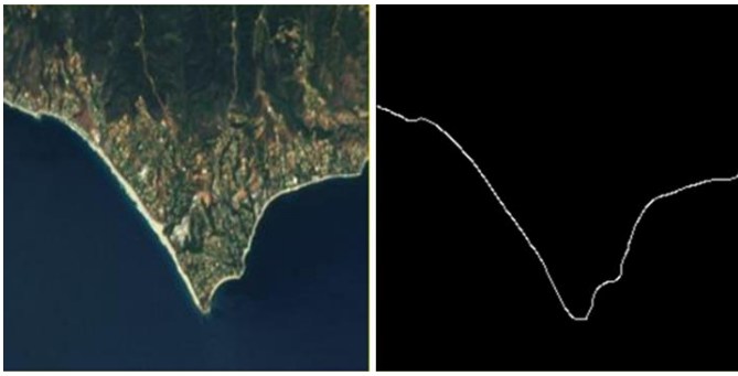
Sl. 5 Aerodrom Nica (satelit LANDSAT 7 ETM+), levo - originalna slika, desno - detektovana ivica, pt=(0.299, 0.587, 0.114, 0, 255, 0, 255, 5 \times 5, 46, 238, 49, 81)
