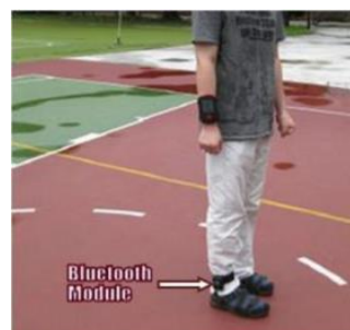
Slika 14. Prenos podataka o hodu preko bluetooth modula [22]
