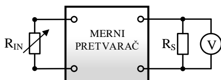
Sl. 1. Blok šema etaloniranja mernog pretvarača električne otpornosti na ulazu, u jednosmernu struju na izlazu
