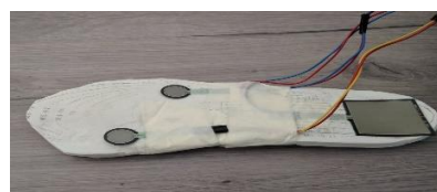
SI. 4. Uložak u kojem su postavljena 3 FSR senzora [7]
