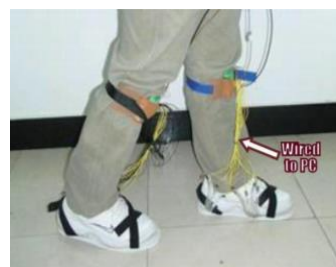
Slika 13. Prenos podataka o hodu preko žice [21]
