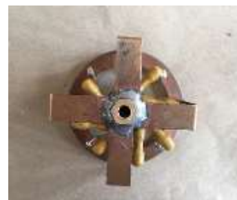
Sl. 5. Fotografija niskonaponskog kondenzatora.
