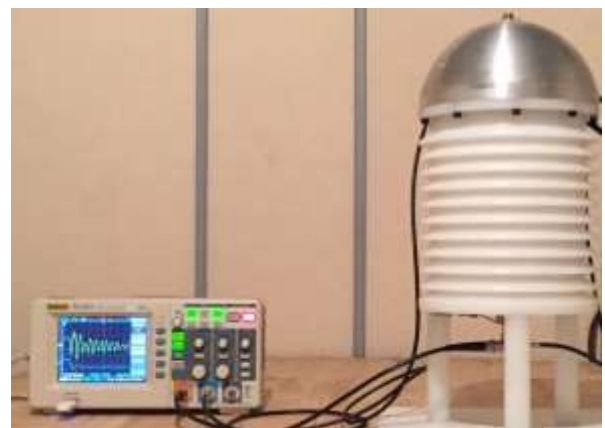
Sl. 8. Fotografija sistema za snimanje odziva delitelja na pravougaoni impuls.
