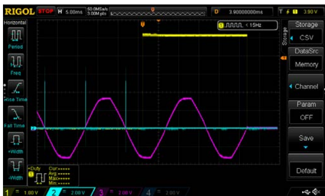
Sl. 2 Izgled signala dobijenih akvizicijom sa multifunkcijskog kalibratora Time Electronics 5030
