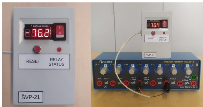
Sl. 9. Izgled samog uređaja (levo) i uređaj povezan na dekadnu kutiju (desno)
