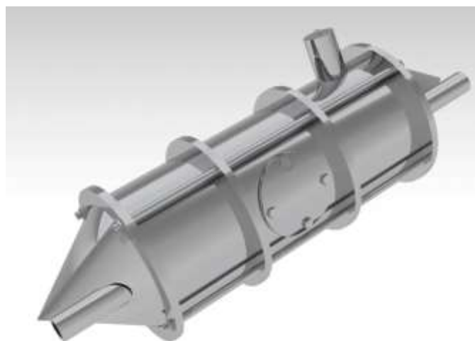
Sl. 2. Model horizontalnog dela elektronskog generatora.
