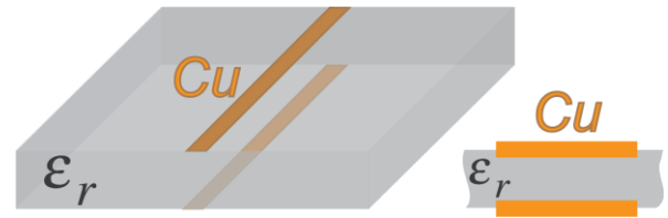
Sl. 1. Balansni mikrostrip vod od bakarne folije na dielektriku.
