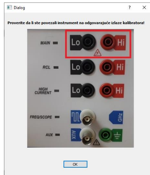
Slika10. Povezivanje instrumenta na izlaze kalibratora
