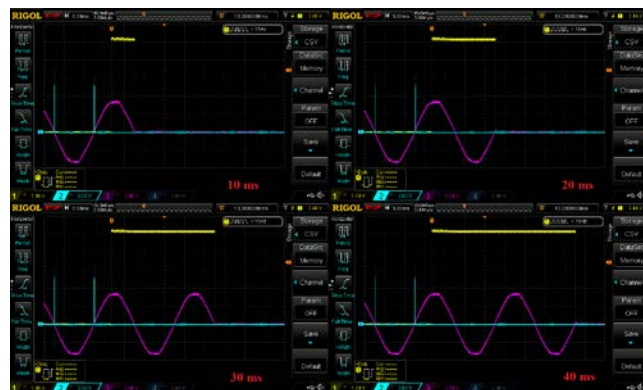
Sl. 3 Izgled signala dobijenih akvizicijom sa multifunkcijskog kalibratora Time Electronics 5030 pri različitim vrednostima vremena reakcije
