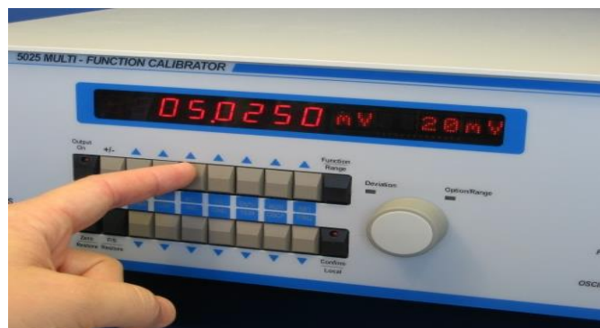
Slika2. Ručno podešavanje izlaza kalibratora
