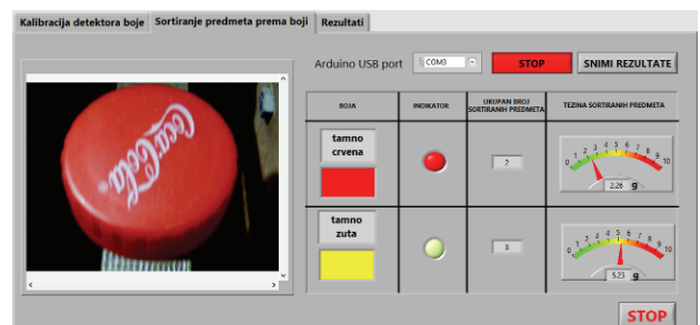
Sl. 5. Izgled LabVIEW aplikacije - kartica Sortiranje predmeta prema boji.
