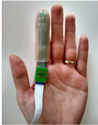
Sl. 2. Tehnički crtež elektrode (lijevo) i njeno pozicioniranje na vrh kažiprsta (desno).
