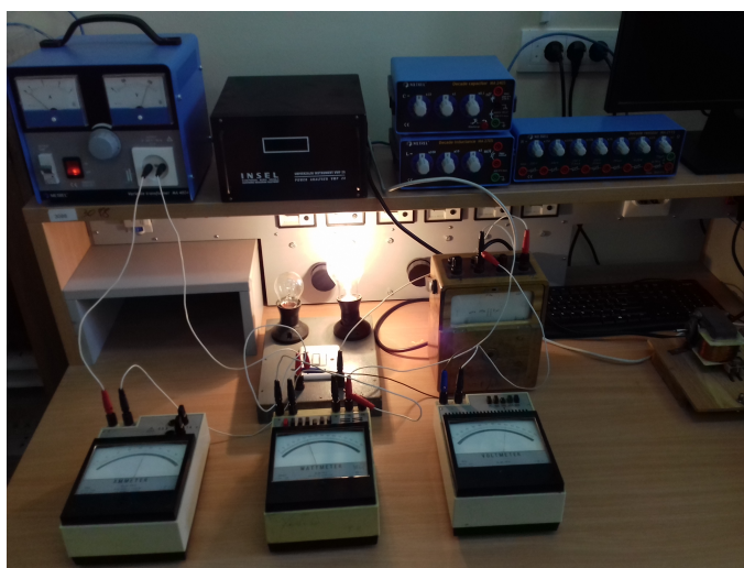
Sl. 4. Izgled merne opreme za izvođenje laboratorijske vežbe primenom standardnih analognih mernih instrumenata.
