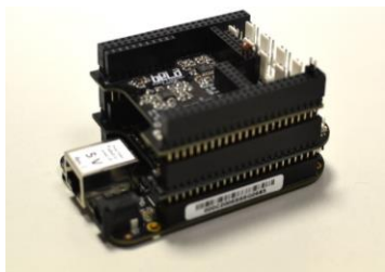
Sl. 5. Hardverska platforma Bela sa audio ekspanderom
