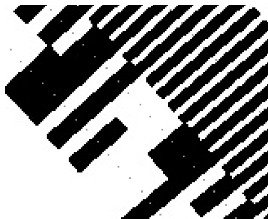
Sl. 5. Izgled dela diska pseudoslučajnog pozicionog enkodera
