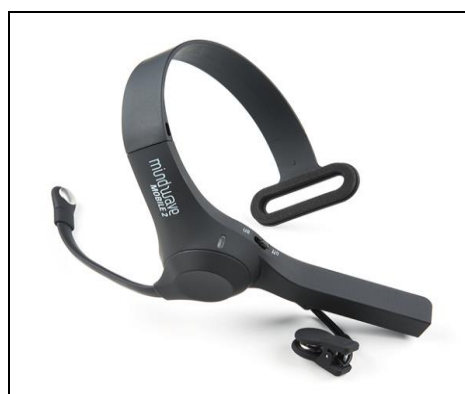
Sl. 1. Neuro Sky Mind Wave 2-EEG biometrijski uređaj [11]
