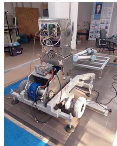
Sl. 2. Blok dijagram hardverske strukture robotskog kontrolera industrijskog humanoida (levo). Sastavljeni prototip robota (desno)..
