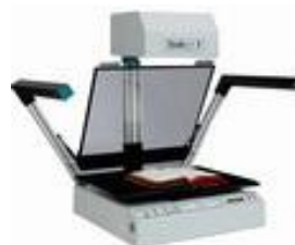
Slika 3. Skeniranje papirne građe (povezane) skenerom sa staklenom pločom – flatbed skener sa kamerom i lampom odozgo (overhead)
