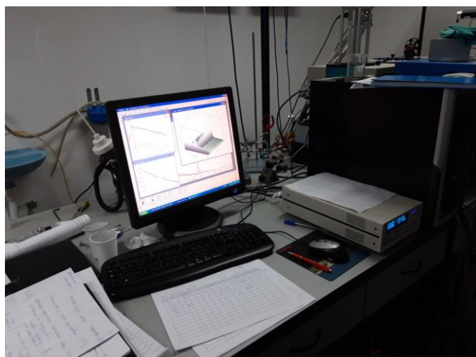
Slika 2. Izgled dela laboratorije sa postavkom za merenje luminescentnih spektara, detalj sa računarom za obradu podataka.
