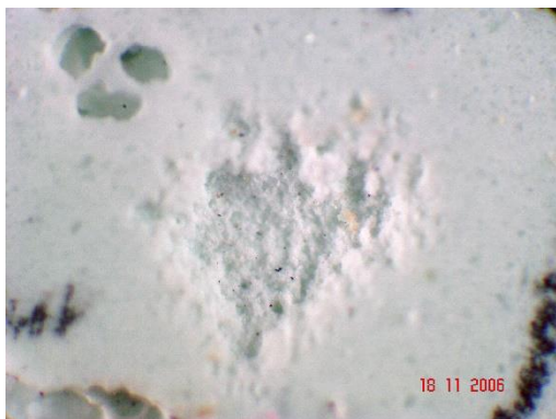
Slika 6. Mikrograf povrede na uzorku HAP-a. (Nd 3+ :YAG, Q-switch, E = 35 mJ, površinska modulacija, OM 40 x)
