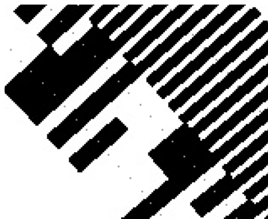
Sl. 5. Izgled dela diska pseudoslučajnog pozicionog enkodera
