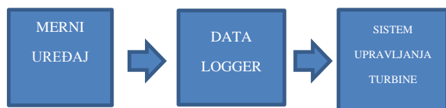
Sl. 1. Blok dijagram mernog sistema vetroturbine
