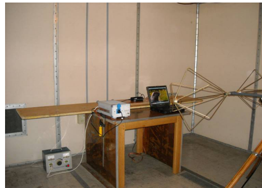
Sl. 1. Ispitivanje nivoa električnog polja EM smetnji.
