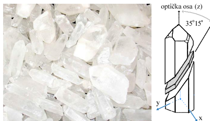
Sl. 1. a) Prirodni kristali kvarca; b) AT rez; električna osa (x) spaja naspramne uglove heksagonalnog preseka, a mehanička (y) je normalna na naspramne površine; svaki kristal ima tri x i tri y ose.
