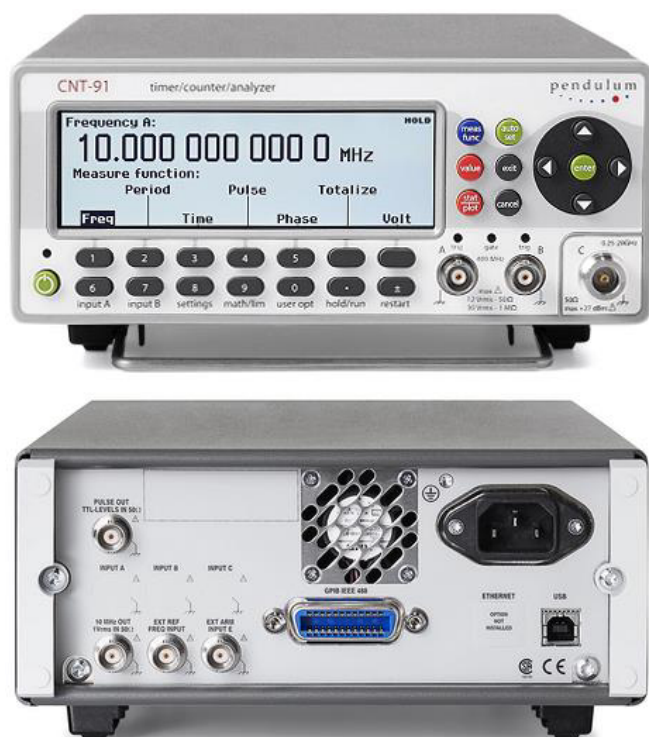
Sl. 3. Pendulum CNT-91 precizni kaunter/tajmer (prednja i zadnja strana) [2]. Ovaj i slični uređaji se koriste za merenje vremena i frekvencije, kao i generisanje signala stabilne frekvencije, u eksperimentima vezanim za proveru sinhronizovanosti.
