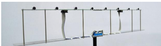
Sl. 8 Upotrebljen mikrofonski niz
