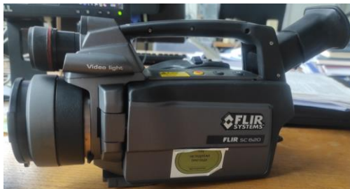
Slika 2. Merna termovizijska kamera FLIR SC 620
