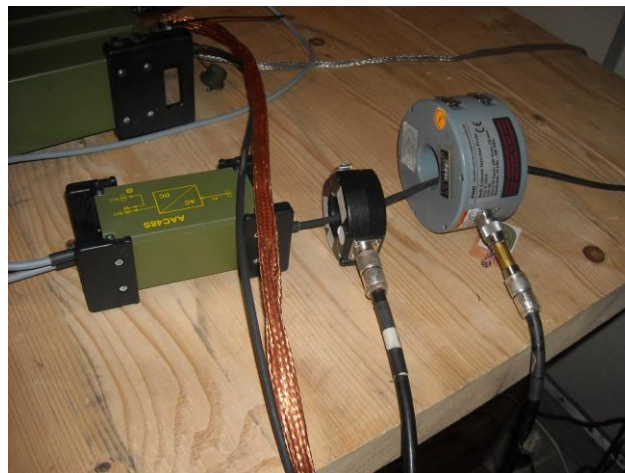
Sl. 5 Deo postavke ispitno-mernog sistema za ispitivanje, CS 114.
