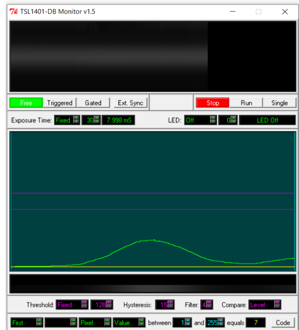
Sl. 7. Očitavanje signala neprozračnog polja sa inkrementalne trake u programu za monitoring
