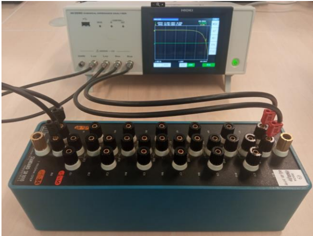
Sl. 19. Merenje impedanse etalona u originalnom kućištu
