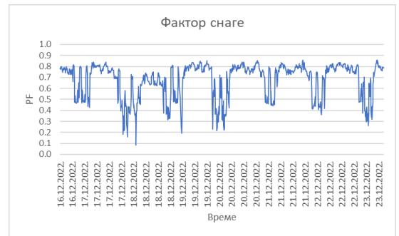
Слика 11 График промене фактора снаге у току мерног периода
