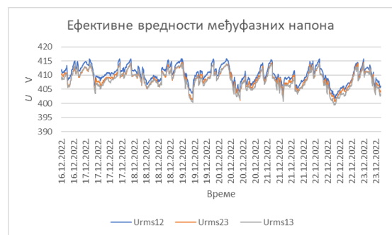
Слика 7 График промене ефективних вредности међуфазних напона у току мерног периода
