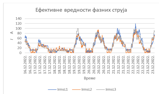
Слика 8 График промене ефективних вредности фазних струја у току мерног периода
