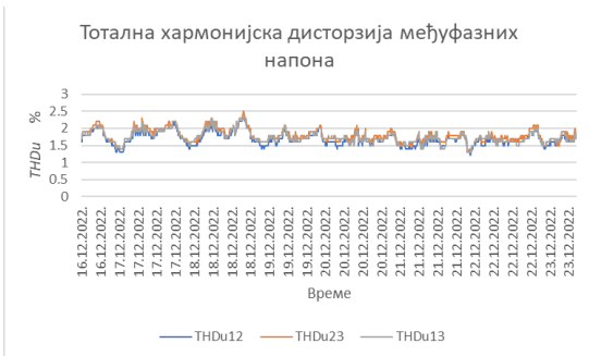
Слика 9 График промене укупне хармонијске дисторзије међуфазних напона у току мерног периода
