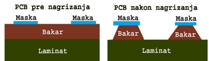
Slika 7. Razlika ostvarene i projektovane debljine provodnika u klasičnoj PCB tehnologiji izrade [18].
