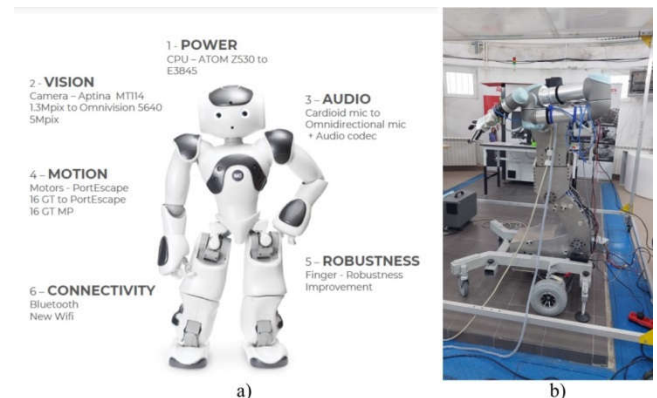
Slika 3. Primeri antropomorfnih robota različite namene: a) NAO društveni humanoid, b) IBCH industrijski kolaborativni servisni humanoid.
