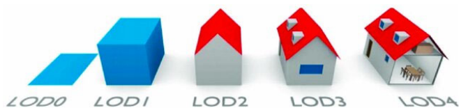
Sl. 1. Standardizovana mera Level Of Detail (LOD) koja ukazuje na nivo detaljnosti modela. Izvor: [15]
