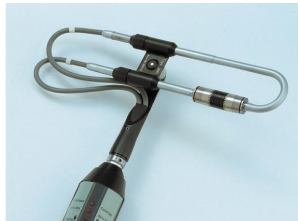
Sl. 4. Intenzitetska sonda korišćena u eksperimentima
