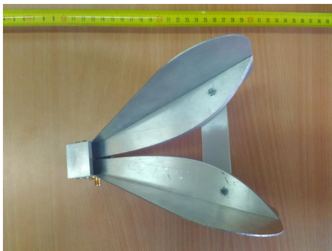
Sl. 5. Pobudna levak antena sa duplim grebenom.
